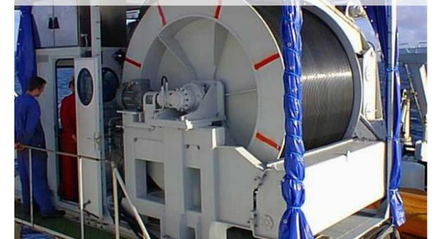
Ein junges, aber ebenso rasch wachsendes Arbeitsfeld für LEBUS-Technologie: Von der Tiefseeforschung und der Untersuchung von Tiefseekabeln und Schiffshavarien mittels Robotern bis zu Spezialaufgaben bei Öl- und Gasplattformen. Auch, weil es dabei um teures Gerät und hohe Investitionen geht, müssen hier mit äußerster Präzision und Zuverlässigkeit Seillängen bis zu 10.000 m gespult werden.
