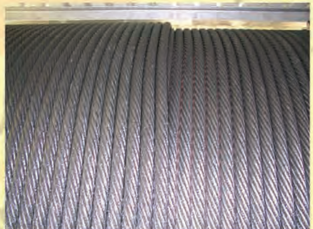
Lebus绳槽卷绕技术任何时候都能够保证钢丝绳排列整齐，从而延长了钢丝绳的使用寿命。
