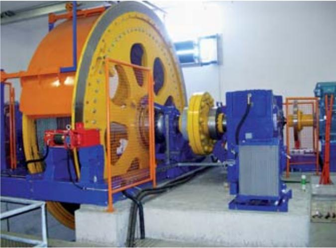
Die Seilwinde der Mürrenbahn (CH), realisiert mit Garaventa, ist eines von vielen Anwendungsbeispielen.
