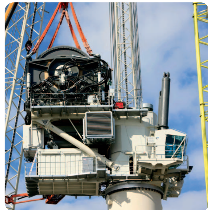
Um ihr Können zu beweisen, wird die Liebherr-Seilwinde für den Testbetrieb auf einen Kran montiert.
